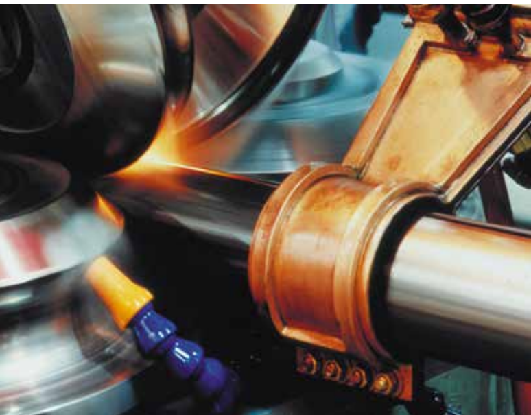
El Weldac puede equiparse con varias bobinas de inducción o con cabezas de contactos de cambio rápido.
