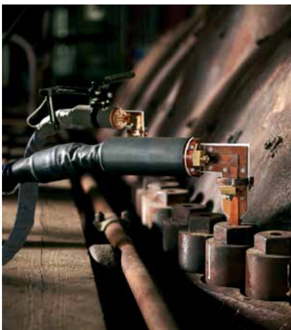
Un ejemplo de –equipo EFD Induction para retirar grandes tuercas y pernos, en una fracción del tiempo necesario por el calentamiento mediante resistencias o gas tradicional.
