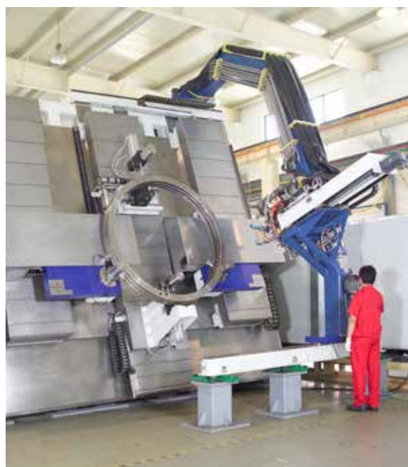
Un gran anillo templado por una máquina EFD Induction con exploración vertical.
