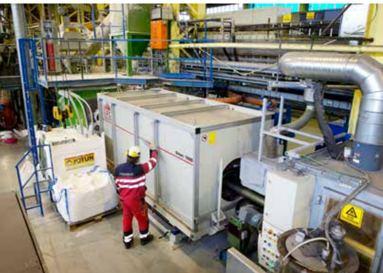
Un Sinac de media frecuencia EFD Induction pre calienta tubería sin soldadura para mar abierto antes de recubrimiento.
