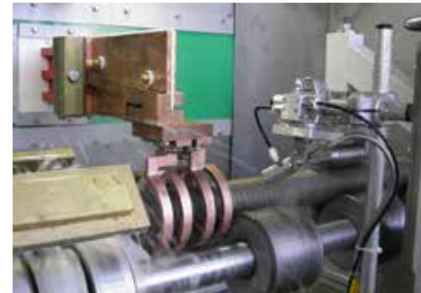
Un eje moviéndose horizontalmente y a alta velocidad a través de una bobina de inducción. El revenido por inducción es inigualable por su velocidad y precisión.
