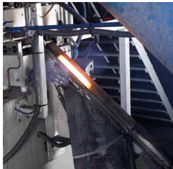
Un taco saliendo de un sistema de calentamiento de tacos EFD Induction. Los tacos calentados son leídos mediante pirómetro y ordenados de acuerdo con la temperatura.
