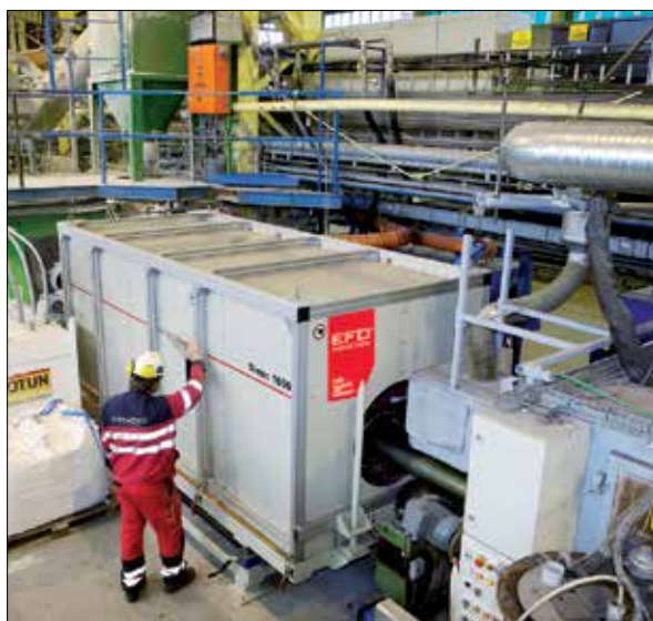
Un sistema a media frequenza Sinac - compensazione serie - impiegato nel preriscaldamento di componenti industriali.
