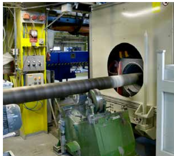
Un ejemplo de pre-calentamiento por inducción. El tubo está siendo calentado antes de darle un revestimiento anticorrosivo.
