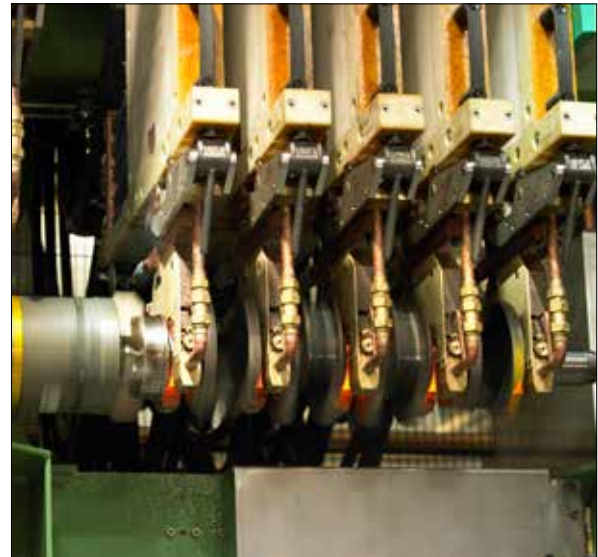
Perfecto para las más duras tareas: cigüeñal sometido a tratamiento térmico en un Sinac.
