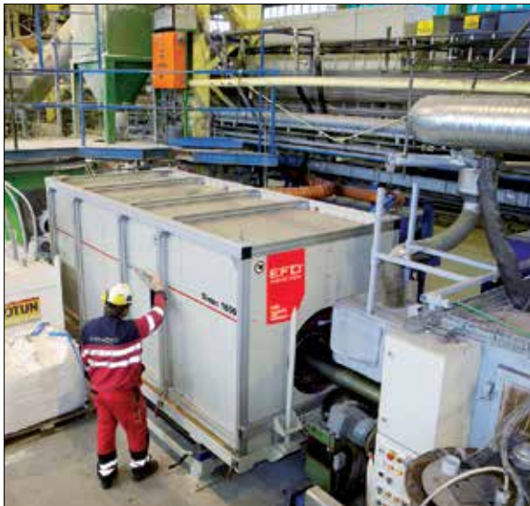
Un Sinac de frecuencia media compensado en serie en acción, precalentando componentes electrónicos.
