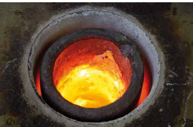
Un horno de EFD Induction trabajando. El crisol de grafito contiene latón fundido.
