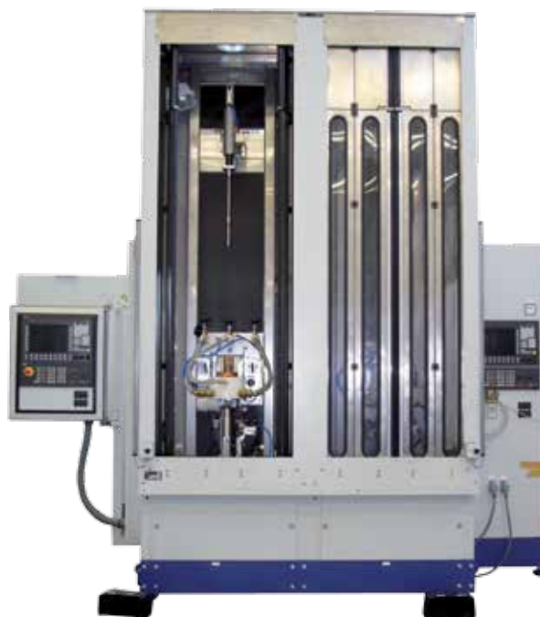
Una máquina de temple vertical EFD Induction en versión doble. El convertidor para esta máquina es un Sinac.
