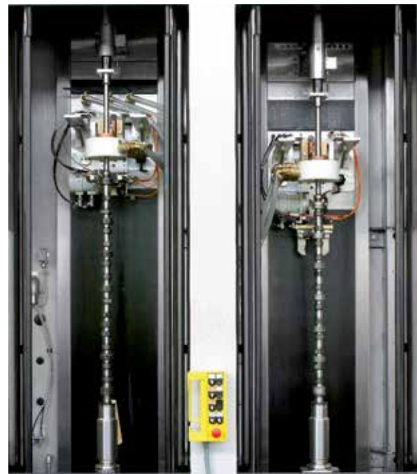
Arriba, una máquina vertical de temple de doble puesto EFD Induction en acción. Izquierda, el duchado simultáneo mediante emulsión polímera de dos árboles de levas.
