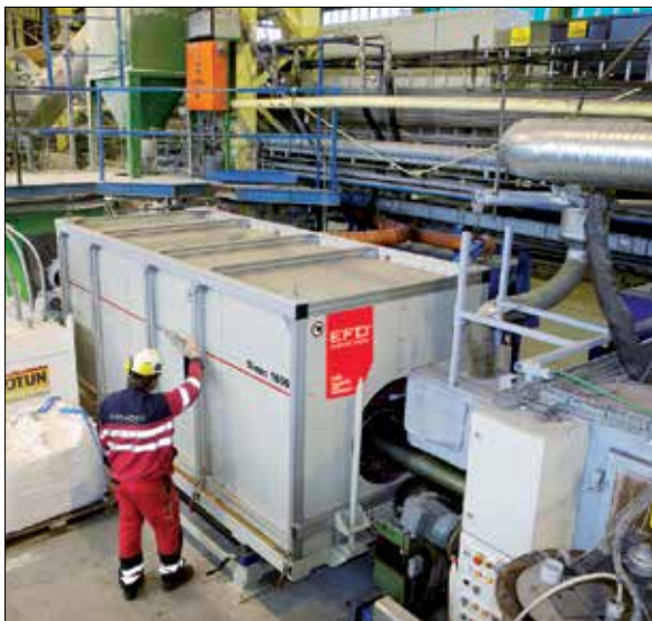
Предварительный нагрев промышленных компонентов среднечастотной системой Sinac с последовательной компенсацией.
