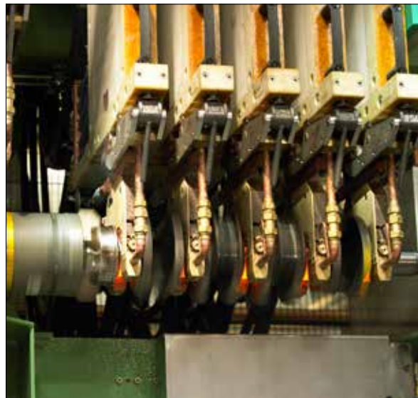
Великолепно подходит для самых сложных видов работ; термообработка коленчатого вала системой Sinac.
