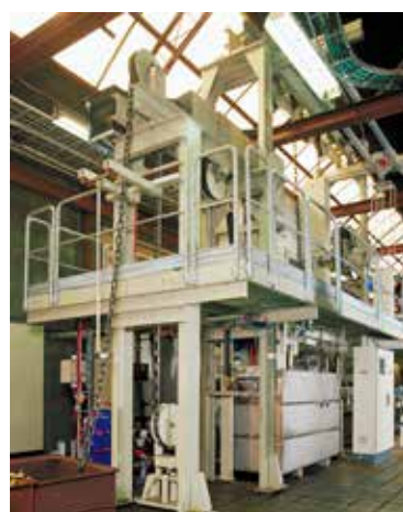
Слева инженеры компании EFD Induction проводят обучение на действующем оборудовании при запуске новой технологии термообработки цепи. Сверху показана цепь, извлекаемая из магазина. Она выходит после закалки и отпуска с одного конца линии и автоматически транспортируется в стационарный магазин или паллету.
