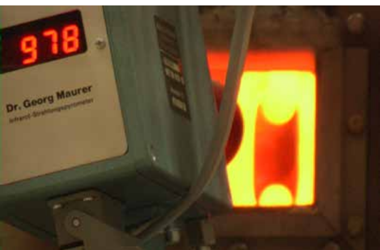
Оптический тепловой датчик измеряет температуру цепи. Датчик является одним из множества элементов обеспечения качества, доступного при термообработке цепи с применением решений компании EFD Induction.
