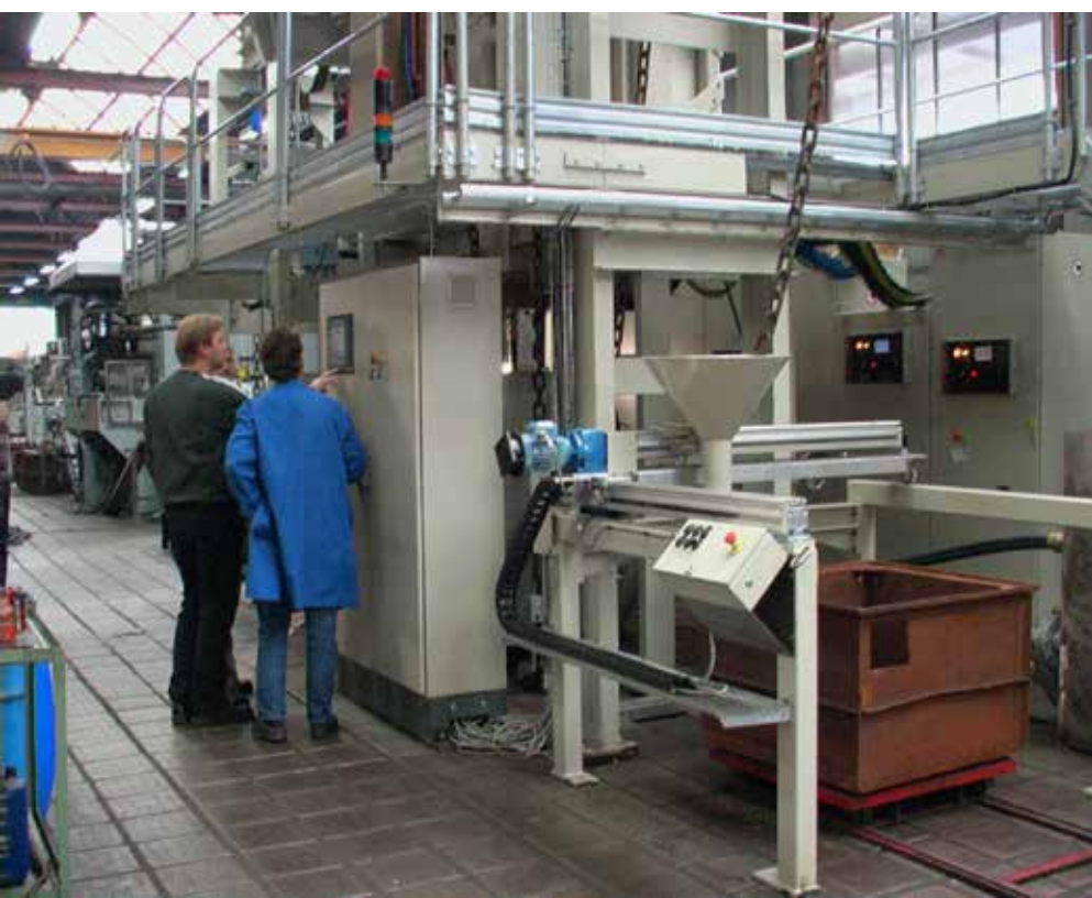
Слева инженеры компании EFD Induction проводят обучение на действующем оборудовании при запуске новой технологии термообработки цепи. Сверху показана цепь, извлекаемая из магазина. Она выходит после закалки и отпуска с одного конца линии и автоматически транспортируется в стационарный магазин или паллету.
