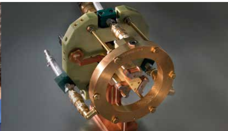
Induttore per la tempra superficiale di tripodi. La testa dell'induttore è dotata di concentratori di flusso magnetici e docce di raffreddamento.
