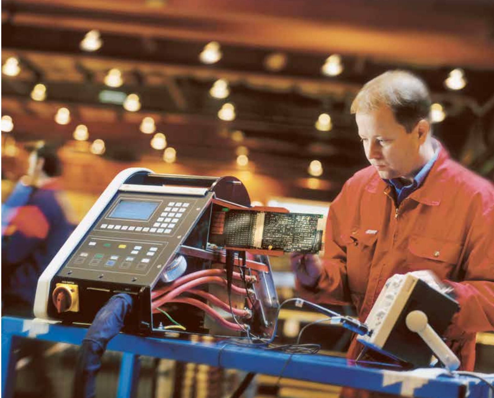
I servizi offerti da EFD Induction spaziano dalla pianificazione pre-produzione e dall'analisi dei materiali a contratti onnicomprensivi di manutenzione preventiva e correttiva. Nell'immagine, un tecnico impegnato con l'upgrade di un sistema di riscaldamento a induzione mobile EFD Induction Minac.
