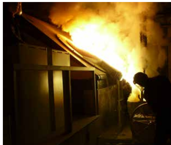
FIB ist unsere Reihe für kippbare Schmelzöfen mit sechs Achsen. Der eisenlose FIB (hier abgebildet) bietet ein innovatives Spulendesign für höchste Effizienz.
