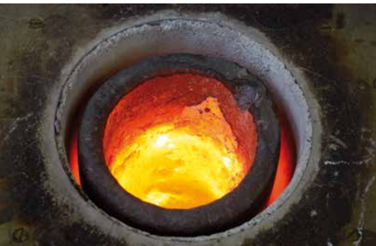
Ein Schmelzofen von EFD Induction im Einsatz. Dieser Grafittegel enthält geschmolzenes Messing.
