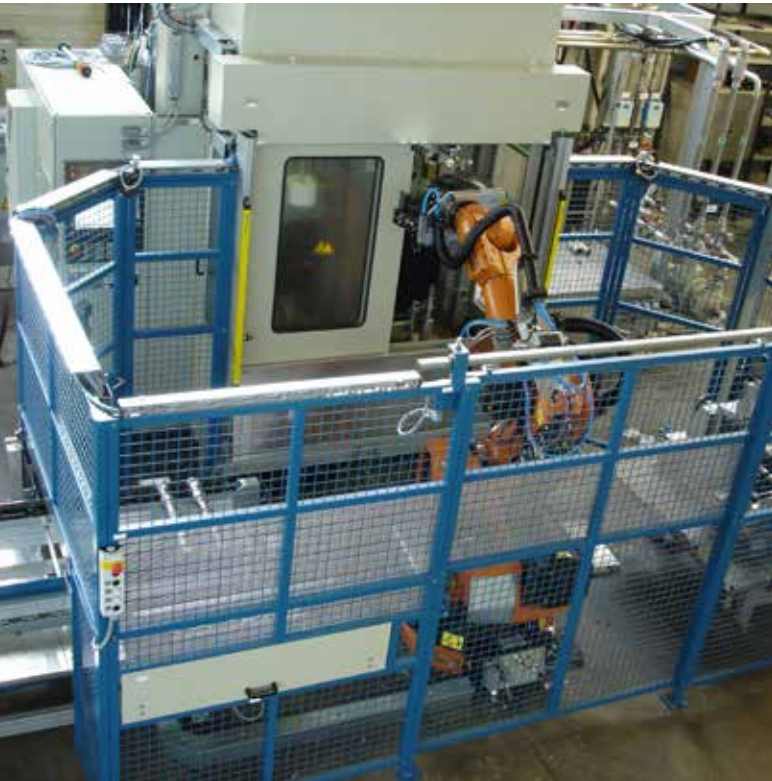
Für mehr Produktivität: eine vertikale HardLine-Härtemaschine mit automatischer Be- und Entladung von EFD Induction.
