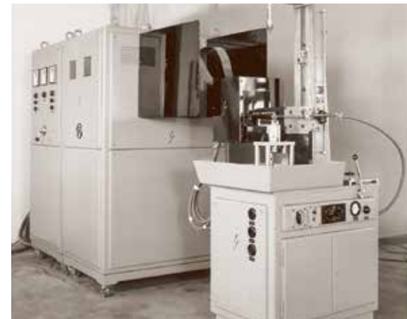
Der Pionier – die erste stationäre Induktionshärteanlage von FDF ist Ende 1950 fertig zum Versand.
