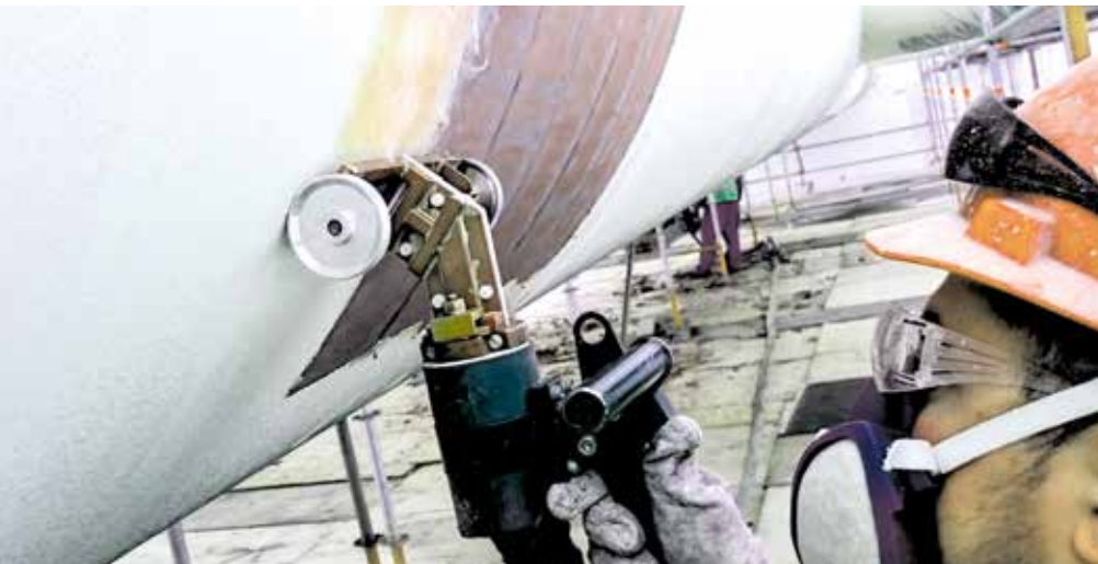
Das Entschichtungssystem trägt industrielle Beschichtungen in fast jeder beliebigen Dicke ab.
