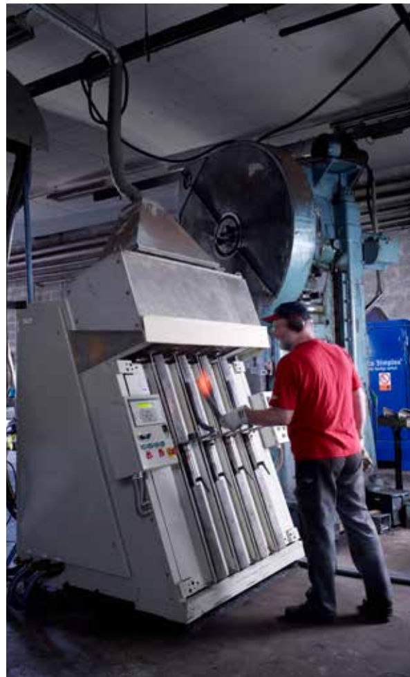
Vertikale CHV-Heizung von EFD Induction. Das CHV-System eignet sich für alle Profilarten, einschließlich vorgeformten Komponenten und unterstützt die manuelle und Roboterbeschickung.
