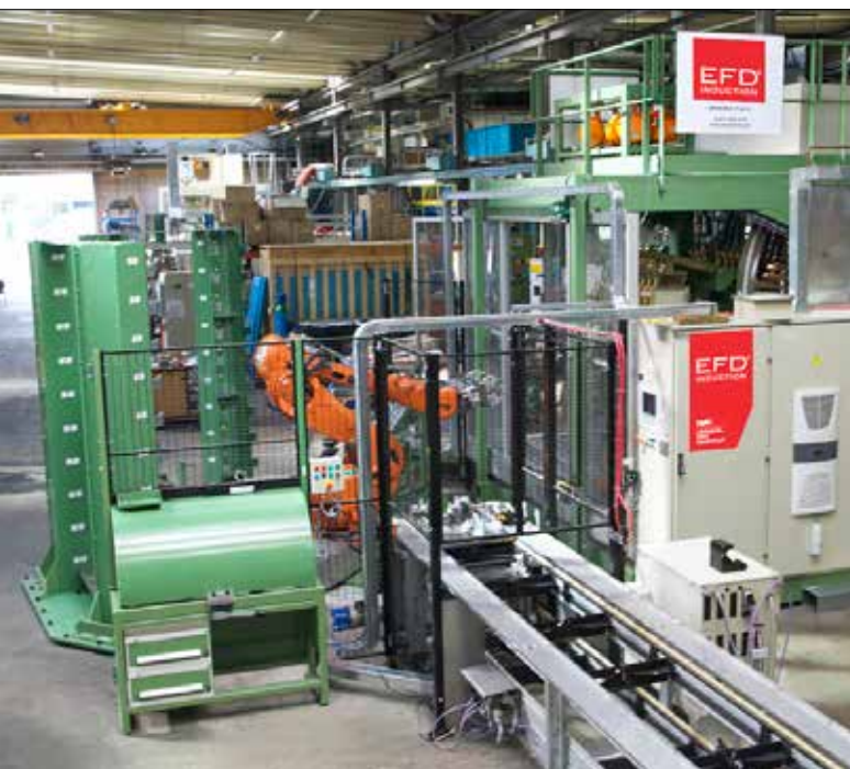
Un Sinac de moyenne fréquence compensé en série, en opération de préchauffage de composants industriels.
