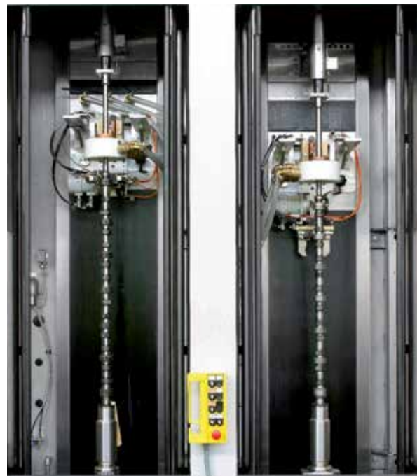
Ci-dessus, une machine de trempe par induction à défilement vertical d'EFD à double station en action. À gauche, bain simultané à émulsion polymère de deux cames d'arbre à cames.
