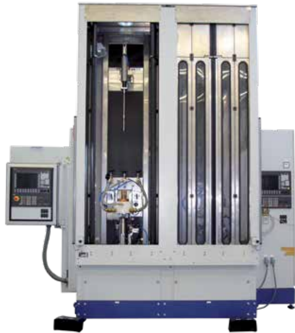
Machine de trempe par induction à défilement vertical d'EFD double poste. Générateur EFD Induction de type SINAC.
