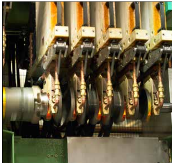
处理高难度工件的理想选择;曲轴热处理中的Sinac
