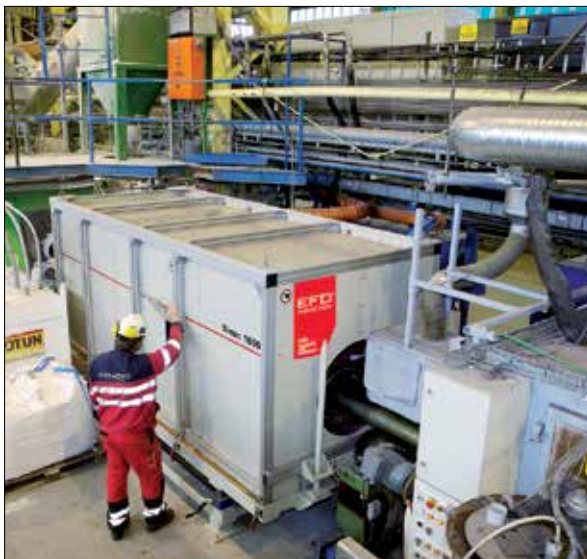
工作中的串联补偿型中频Sinac,工业零件预热
