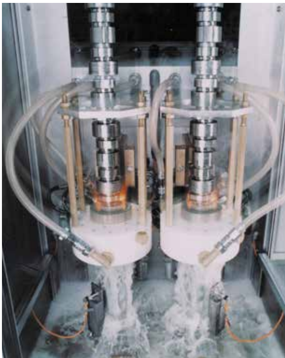
双淬火得到双倍的生产率。带双尾座和顶心的单柜式淬火机内的淬火状态。
