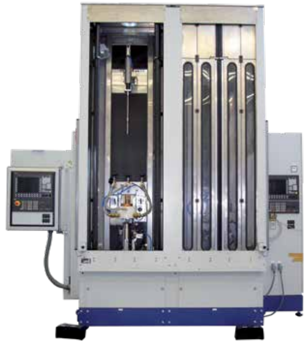
双工位EFD Induction立式淬火机。电源选用EFD Induction Sinac系列。
