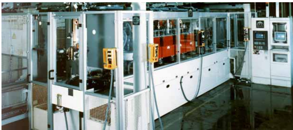
全套 EFD Induction 回火方案通常包括电源、线圈、输送机构及控制软件。同时还可提供培训、保养和维修。
