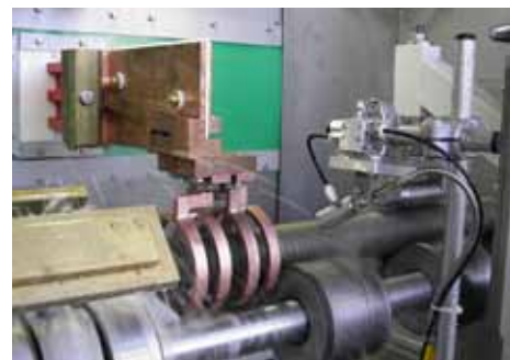
一个轴高速移动通过感应线圈。感应回火拥有无与伦比的速度和精确度。
