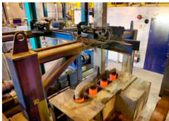
无灰尘、无烟、无噪音。EFD Induction 加热器能夹住 170 毫米的阳极棒。
