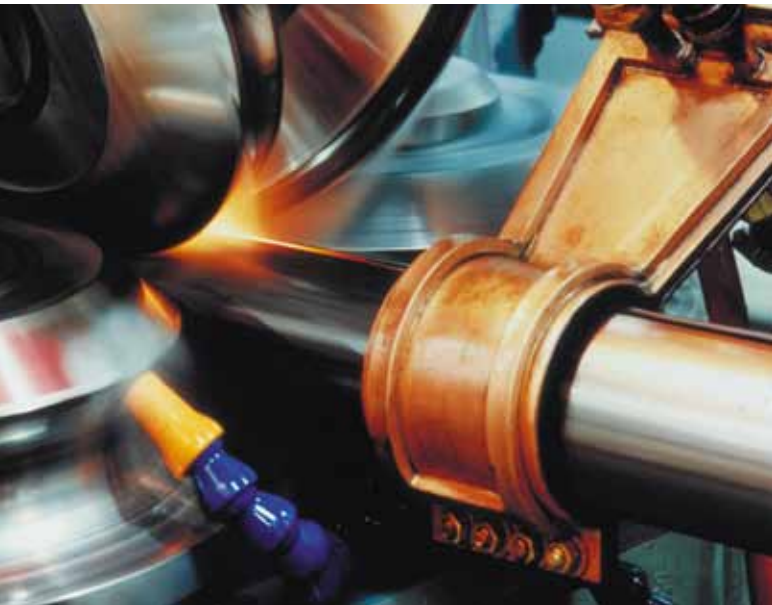
Weldac 可配备各种感应线圈或快速升降接触式焊头。
