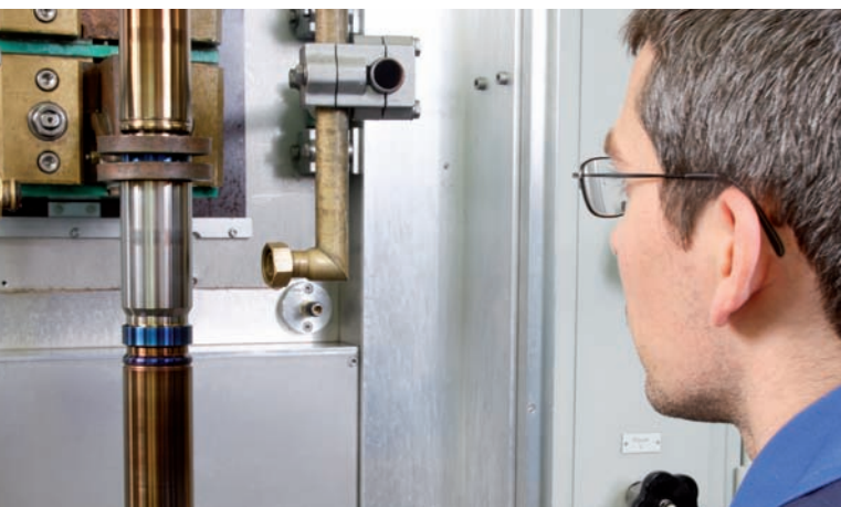
Macchina di tempra a induzione verticale EFD Induction in azione. L'attacco per mandrino dietro il pezzo consente di utilizzare la stessa macchina per la tempra sia ad alta che a media frequenza.
