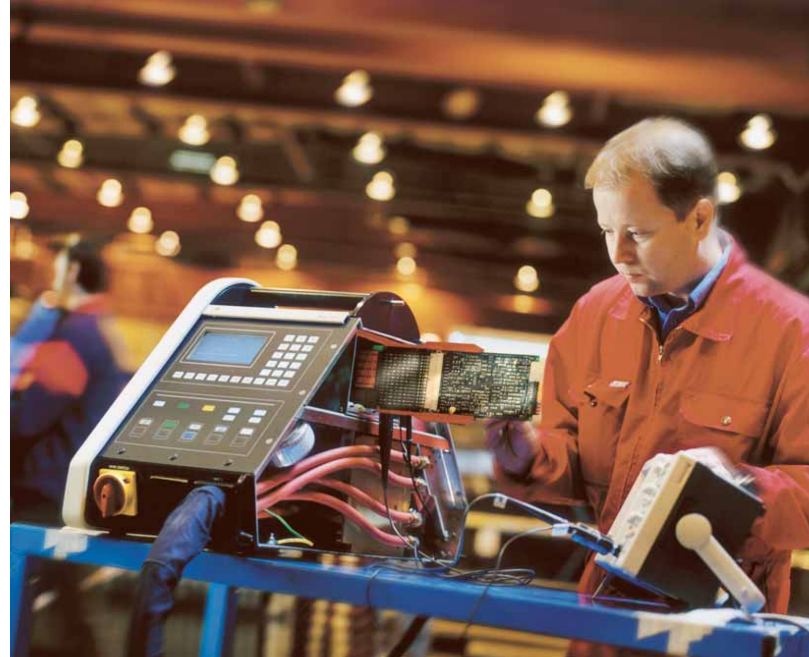
Los servicios de EFD Induction cubren desde la planificación previa a la producción y el análisis de materiales hasta contratos completos de mantenimiento preventivo y correctivo. En la foto, uno de nuestros ingenieros actualiza un sistema de inducción móvil Minac de EFD Induction.
