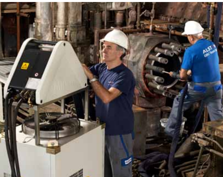
Un ejemplo de –equipo EFD Induction para retirar grandes tuercas y pernos, en una fracción del tiempo necesario por el calentamiento mediante resistencias o gas tradicional.
