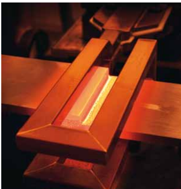
Braseado con un sistema EFD Induction. Vean como con inducción la zona de calentamiento es totalmente visible, algo que es imposible con calentamiento por llama.
