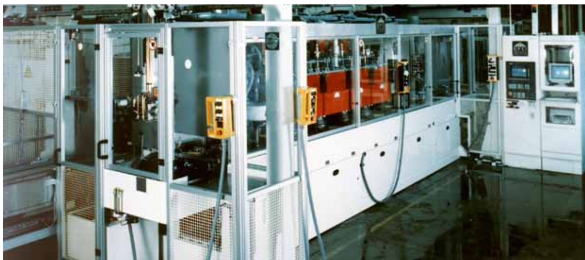
Un equipo de revenido completo EFD Induction normalmente incluye: el convertidor, las bobinas, los mecanismos de manipulación y el software de control. También tenemos disponibles opciones de servicio, mantenimiento y formación.
