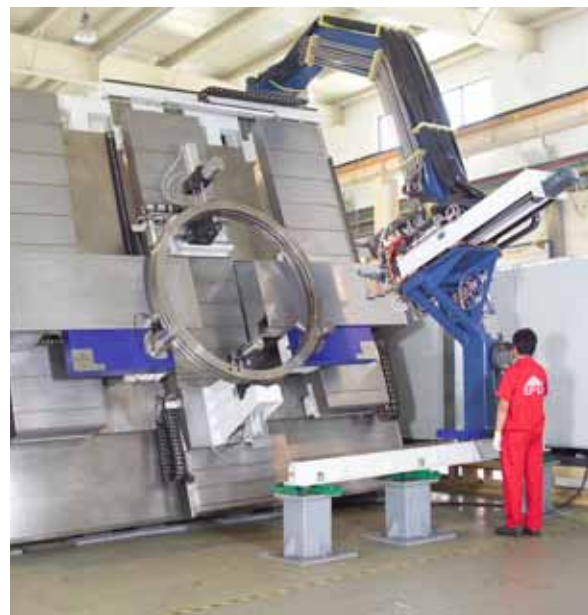
Un gran anillo templado por una máquina EFD Induction con exploración vertical.
