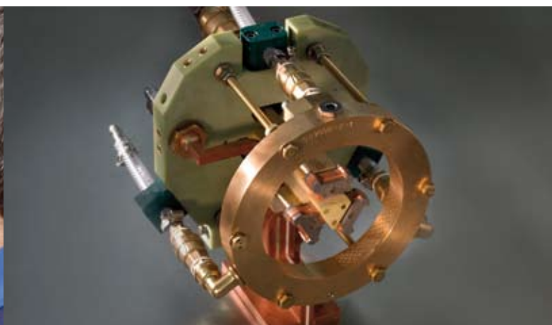
Inductor para el temple de superficies de trípodos. El cabezal del inductor está equipado con concentradores de campo magnético, ducha principal y pantallas de enfriamiento final.
